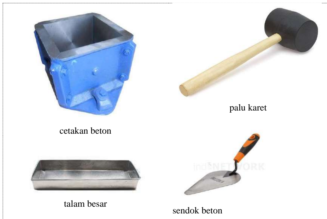
Gambar 7.3 Alat-alat pembuatan benda uji beton
