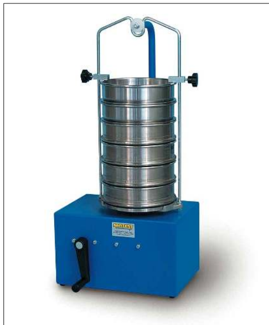
Gambar 5.2 Satu set saringan dengan alat penggetarnya
