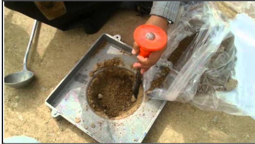
Gambar 7.2 Proses penggalian tanah pada uji sand cone
